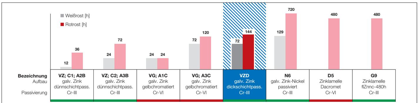
Korrosionsbeständigkeit handelsüblicher Oberflächen, getestet in SSN-Test DIN EN ISO 9227 mit Bezeichnung, Schichtaufbau und Art der Passivierung, logarithmisch aufgetragen.
