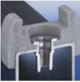
Zwei Funktionen: Nieten und Schrauben
