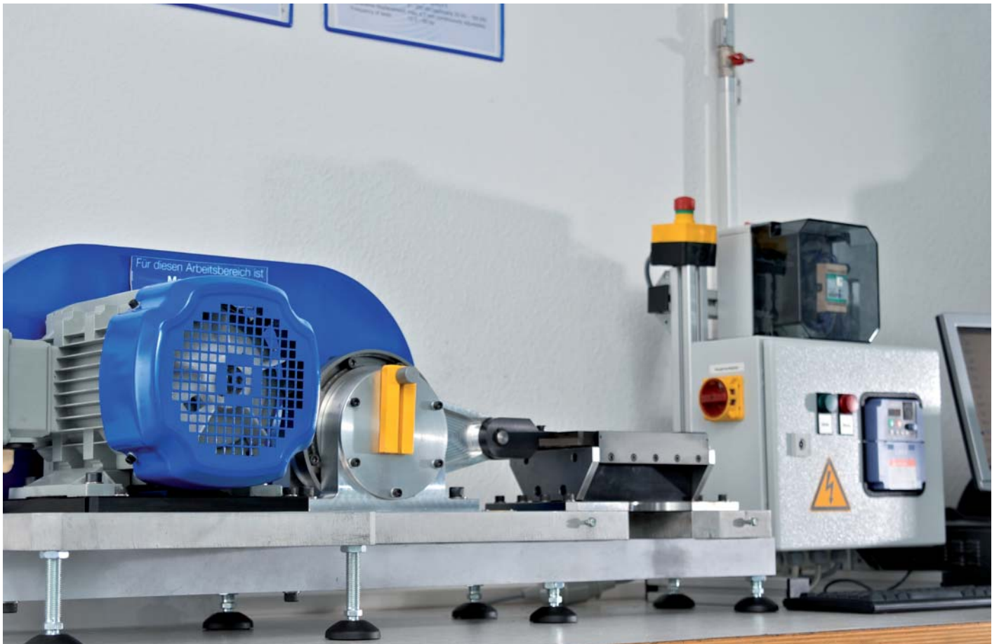
Rüttelprüfstand Böllhoff Labor
